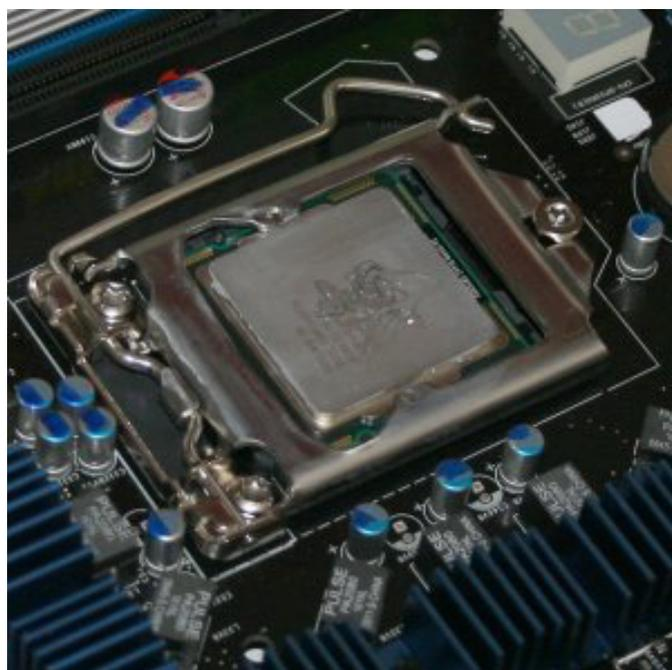
Le support du MUX-120 se fixe via 4 vis et une contre plaque qui prend place au dos de la carte mère. Le support LGA 1156 ayant 3 points d'ancrage, attention au sens de cette contre plaque ! Il faut également choisir le sens de montage des attaches du radiateur selon l'orientation voulue. Tout ceci est heureusement plus simple à faire en pratique qu'à écrire...
