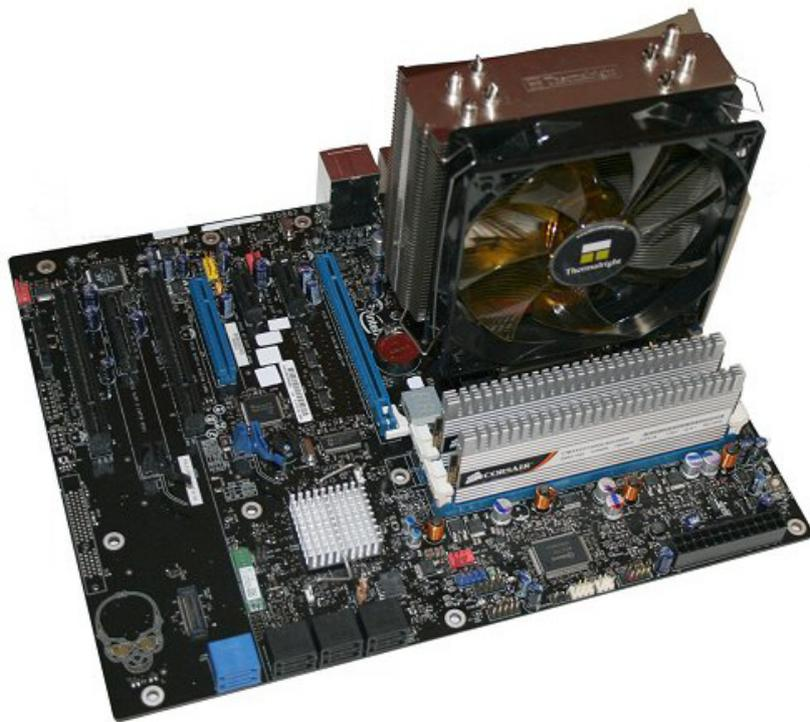
La dernière étape consiste à monter le ventilateur. Attention à bien l'orienter de manière à ce que le flux d'air soit dirigé vers l'arrière du boîtier (montage vertical) ou vers le haut (montage horizontal). N'oubliez pas de brancher le ventilateur sur la prise « CPU Fan » ! Rangez les fils du ventilateur pour éviter qu'ils ne touchent les pales et qu'ils entravent le moins possible la ventilation. Un petit collier de serrage permet un montage bien propre.
