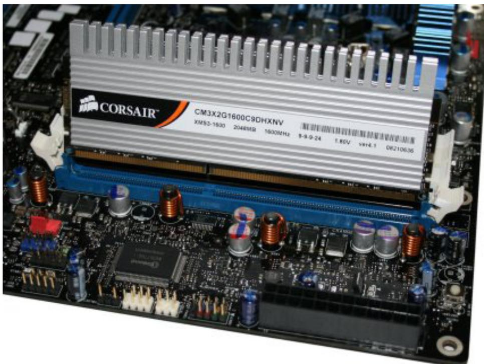
Ouvrez les loquets blancs des banques de mémoire puis insérez la barrette verticalement. Vérifiez si l'encoche est bien face au bossage puis enfoncez le module dans son logement. Les loquets de verrouillage se fermeront dans la foulée...
