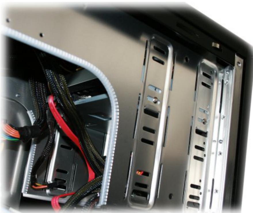
Les disques durs se montent par contre sans outil. Il suffit de serrer 4 grosses vis à main avec une rondelle en caoutchouc sur le disque puis de le glisser dans son logement. Un coulisseau avec une vis à main maintient les disques en place. Ce système rapide à mettre en œuvre présente aussi l'avantage d'éviter la transmission des vibrations éventuelles du disque dur au reste du boîtier.
